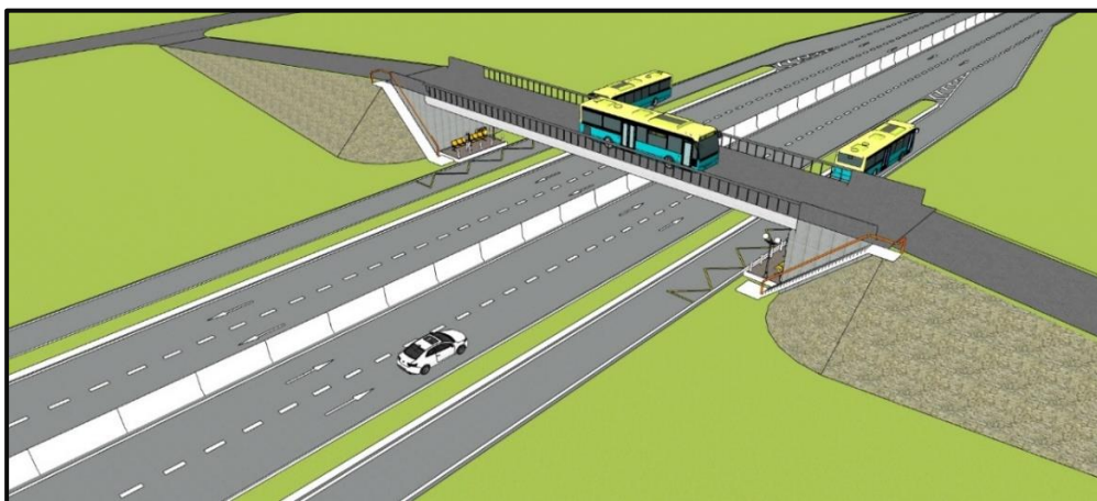
Hình 10 – Minh họa bố trí điểm dừng đón, trả khách nơi giao nhau với cầu vượt (kiểu A)
